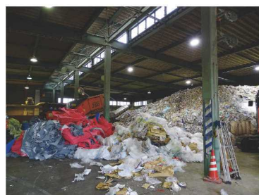
RPF の原料となる廃棄物 オレンジ色の破砕機で細かくされる
