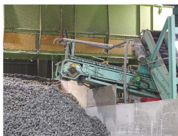
破砕された廃棄物は RPF 成型機で 5 cm 程度の大きさに圧縮される
