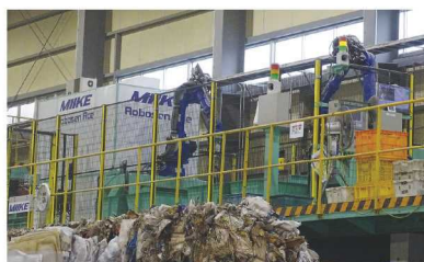
2台のロボットで素材別に選別する
